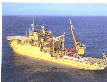
"Seaway Pelican" la om tre gassrørledninger - eksportrørledningen til Emden, til Gyda og til Tor. Arbeidet med Emden-ledningen på 36 tommer tok i underkant av sju dager mens de to mindre rørledningene ble kuttet og sveist sammen i løpet av knappe fem dager.
